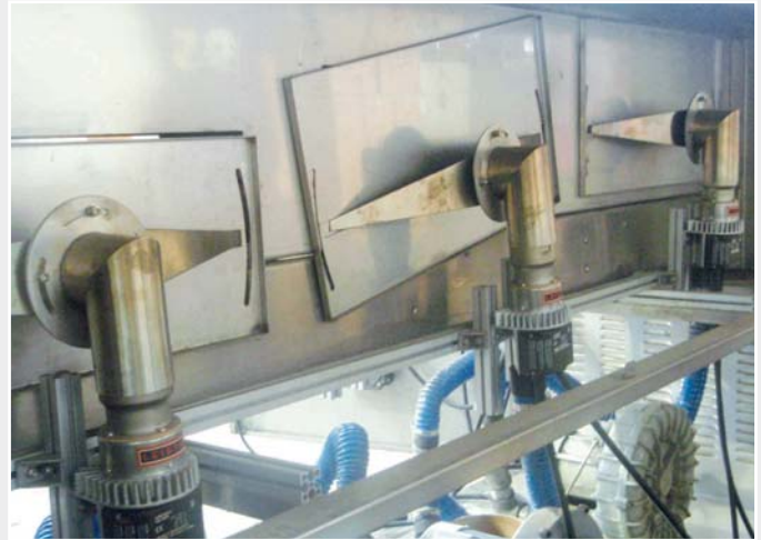
Ajuste individual de las boquillas de ranura ancha Leister en el objeto que se va a encoger.
